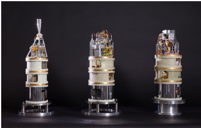
(上) 国際協力の下でチリで運用されているアルマ望遠鏡 (下) アルマ望遠鏡向けに国立天文台が開発した、左から150/450/900 GHz帯の超伝導受信機
