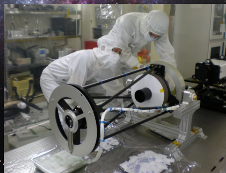
クリーンルームで組み立て中のロケット搭載望遠鏡
