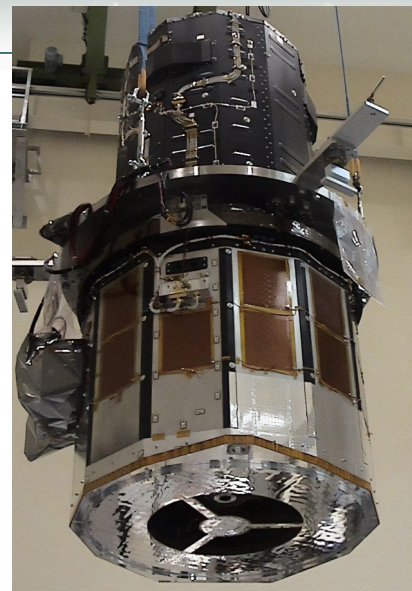
国立天文台クリーンルームで組み立てられた太陽観測衛星「ひので」搭載用の可視光磁場望遠鏡
