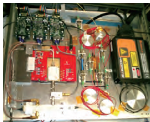
国立天文台が開発した、フォトニック信号発生装置
