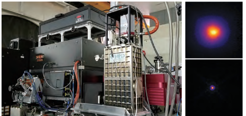
(左) すばる望遠鏡向けに開発された極限補償光学装置 SCEXAO。(右) 補償光学適用前(上)と適用後(下)での星像の違い。補償光学により、星像が圧倒的にシャープになります。
