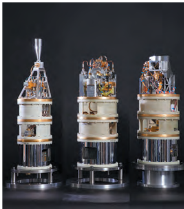
アルマ望遠鏡向けに国立天文台が開発した、左から150/450/900 GHz 帯の超伝導受信機
