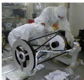
クリーンルームで組み立て中のロケット 搭載望遠鏡
